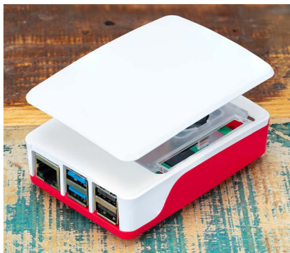
Figura 2-8 Colocando la tapa sobre la carcasa
