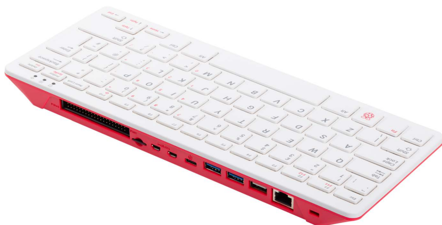
Figura 1-18 Los puertos del Raspberry Pi 400 se encuentran en la parte posterior
