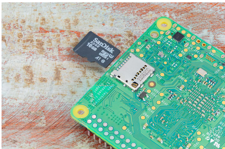
Figura 2-13 Insertando la tarjeta microSD
