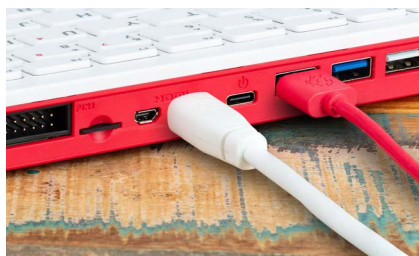
Figura 2-22 Conectando el cable HDMI a un Raspberry Pi 400
