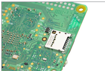
Figura 1-16 Conector de tarjeta microSD de un Raspberry Pi
