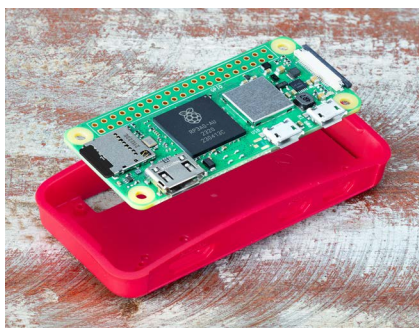
Figura 2-10 Colocando el Raspberry Pi Zero en su carcasa
