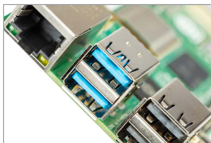
Figura 1-7 Puertos USB de un Raspberry Pi
