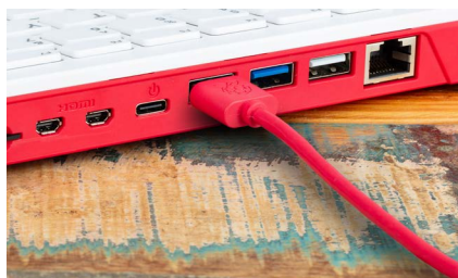
Figura 2-21 Conectando un cable USB a un Raspberry Pi 400
