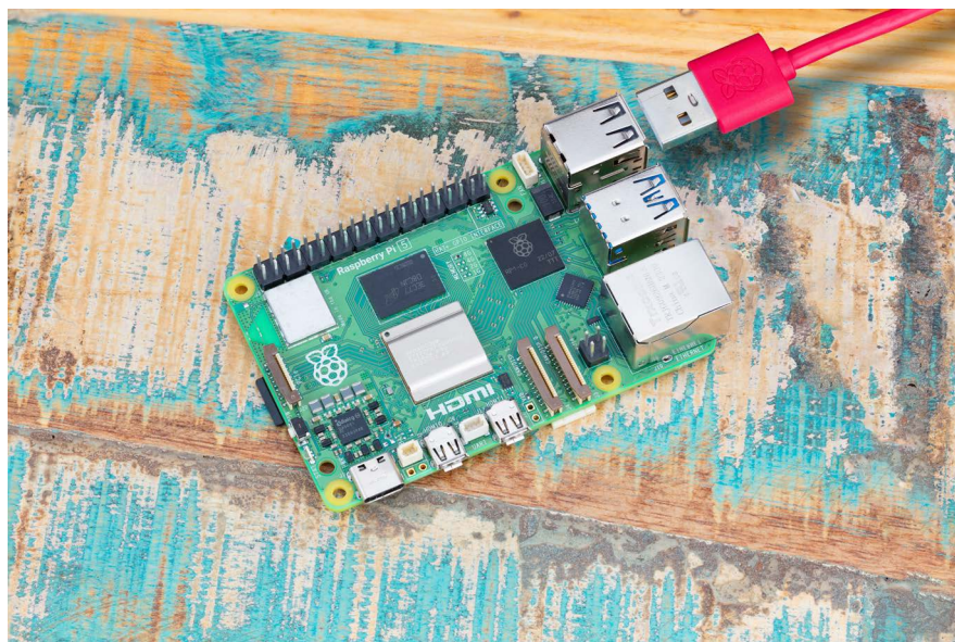
Figura 2-14 Conectar un cable USB a un Raspberry Pi 5
