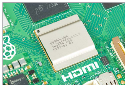
Figura 1-2 Sistema en chip (SoC) de un Raspberry Pi
