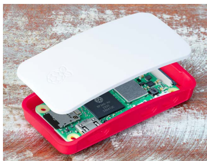
Figura 2-11 Colocando la tapa
