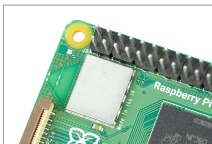
Figura 1-4 Módulo de radio de un Raspberry Pi
